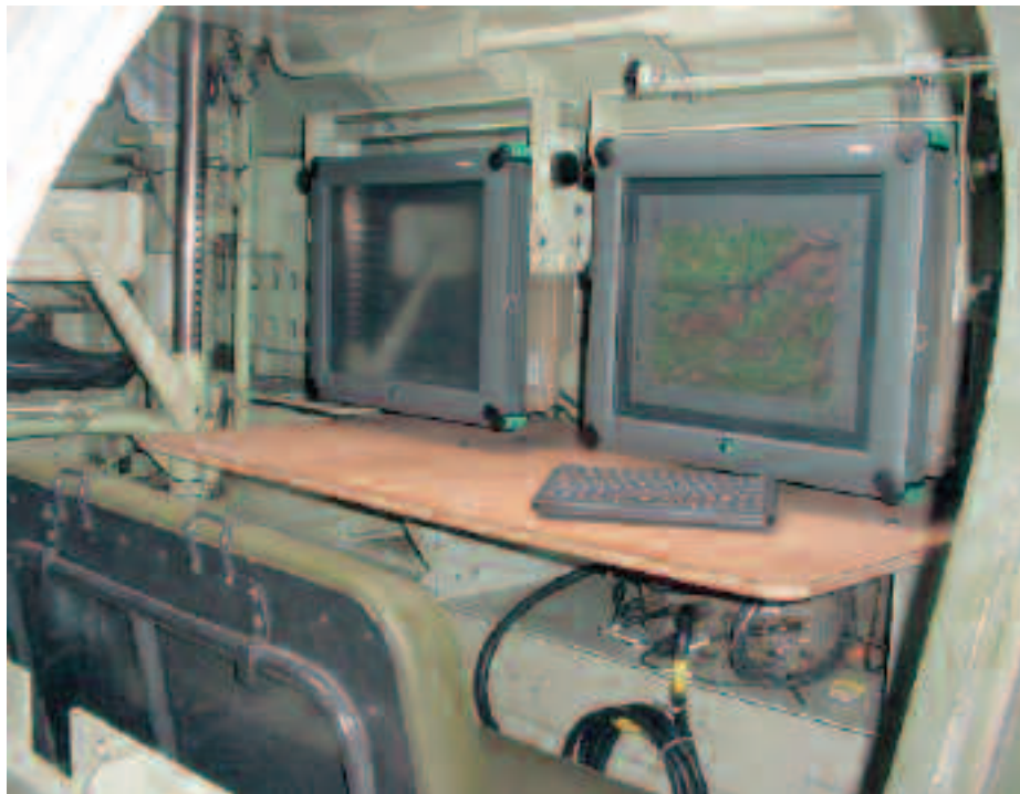
Figuur 7: BMS-computers ingebouwd in een M577
